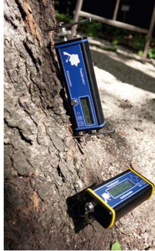
De inclinometer (onder) geeft de stabiliteit weer en de elastometer (boven) de breukgevoeligheid.
